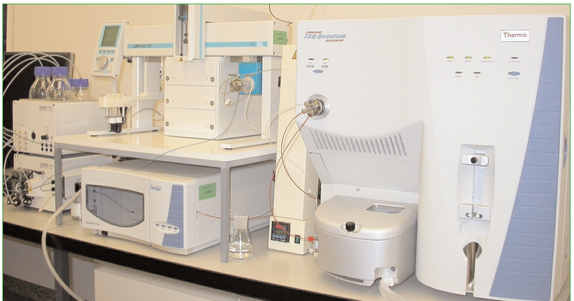
LCMSMS-System mit MS, Säulenofen, Probengebersystem und HPLC-Anlage (von rechts)
